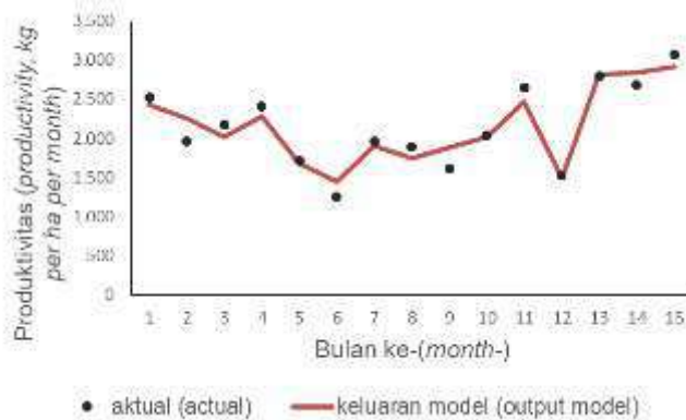
Gambar 5. Keragaan keluaran persamaan regresi berganda dengan peubah prediktor terbaik laju air kapiler tanah (CR), curah hujan (CH), kadar air tanah (KA), interaksi curah hujan dan laju air kapiler tanah (CH*CR), serta interaksi curah hujan dan kadar air tanah (CH*KA) untuk jarak waktu - 20 bulan
